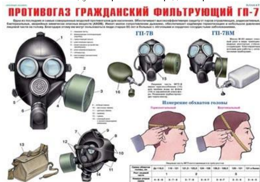
Рис. 1. Противогаз гражданский фильтрующий.
