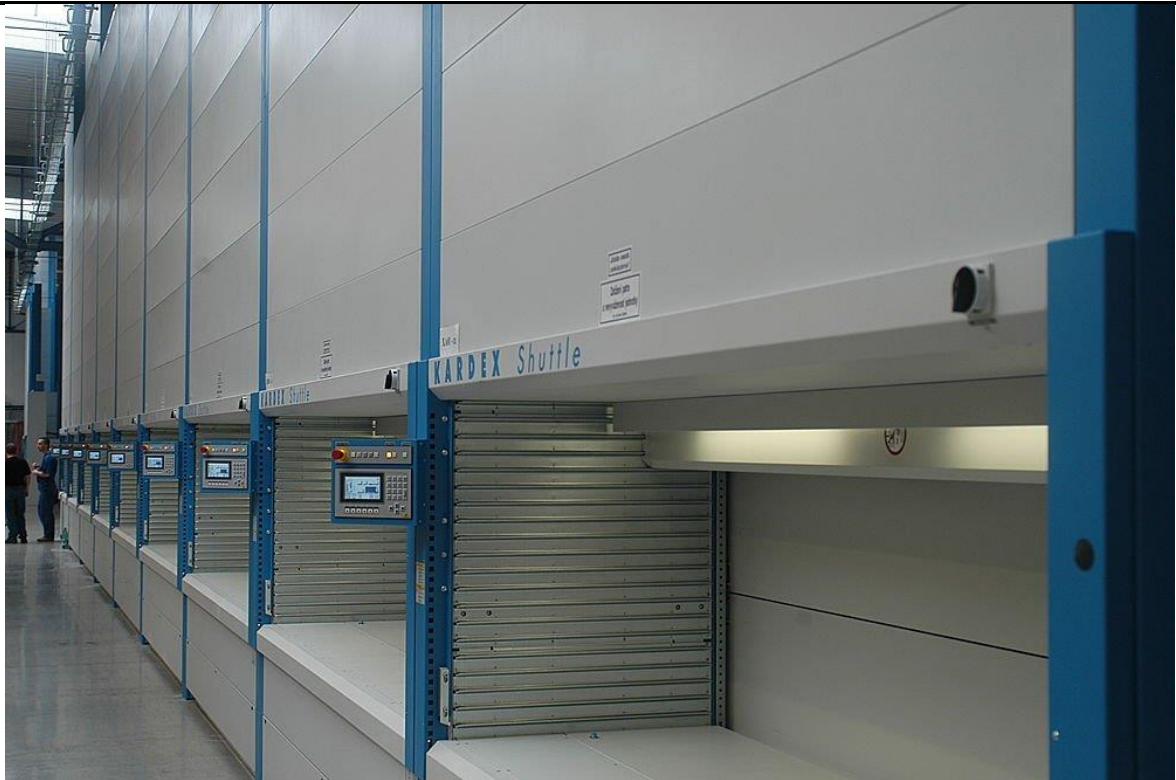
Рис. 4. Лифтовая система хранения
