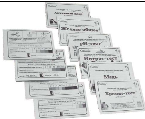
Рис. 1. Тест-системы производства ЗАО «Крисмас+» для сигнального экспресс-контроля воды и водных сред
