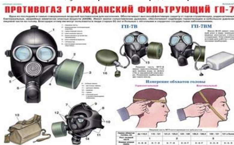
Рис. 1. Противогаз гражданский фильтрующий.
